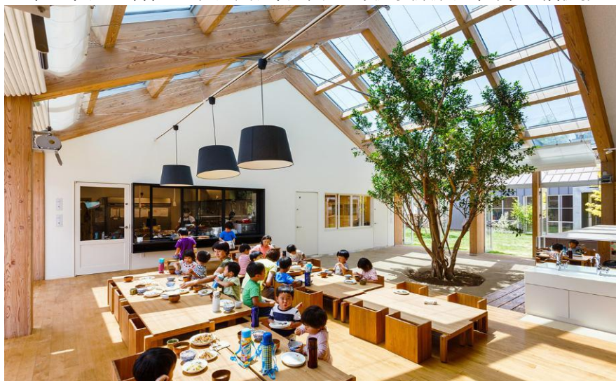
图 4-12 可以使用天窗、以及较大的窗地比来控制室内充足的采光与通风
