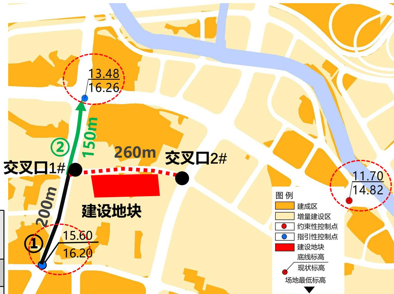
建筑工程底线标高推导计算过程示意图
