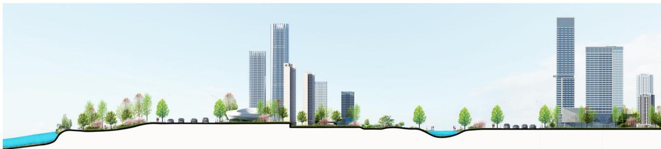
**底线标高 = 河涌水位 + 安全超高 (0.5m) + 水力坡度 × 距离**
