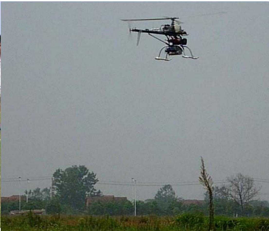
三维测量系统飞行试验
